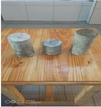
Photo 2 : Éprouvette de béton à la température de 25 °C
