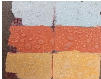
Photo 6 : Test d'imperméabilité à l'eau
