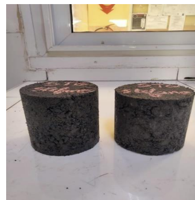
Figure 3 : Eprouvette pour l'essai Duriez
