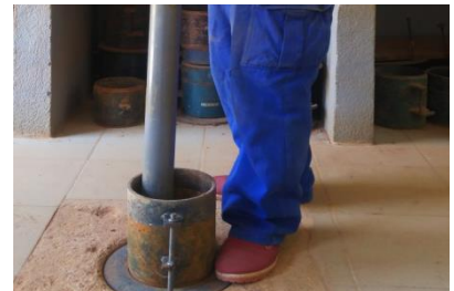
Photo 1 : Essai d'identification de sol (Granulométrie – Limite d'Atterberg – PROCTOR)
