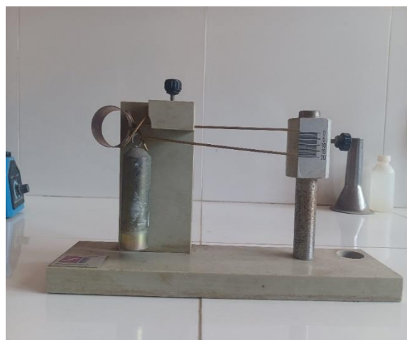
Etalonnage par l'aiguille de Le Chatelier
