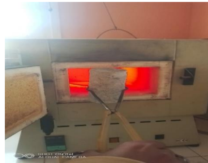
Photo 3 : Cycle d'échauffement de l'éprouvette de béton gravillons de nature granite
