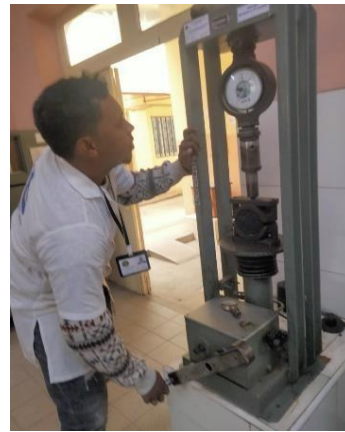
Figure 2 : Ecrasement de l'éprouvette
