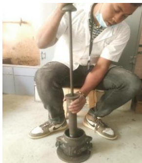
Figure 1 : Compactage de l'éprouvette Marshall
