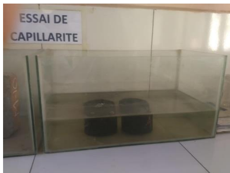
Figure 1 : essai de perméabilité à l'eau
