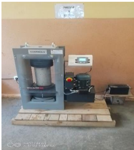
Photo 5 : Ecrasement du béton à la température ambiante
