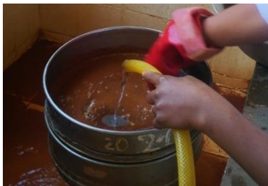
Photo 1 : Essai d'identification de sol (Granulométrie – Limite d'Atterberg – PROCTOR)
