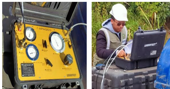
Photo 1 : Appareil de mise en pression de l'eau
