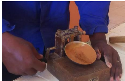
Photo 1 : Essai d'identification de sol (Granulométrie – Limite d'Atterberg – PROCTOR)
