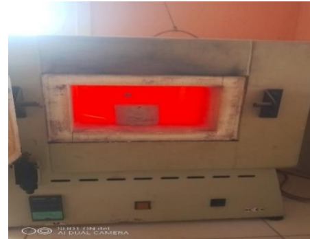
Photo 4 : Cycle d'échauffement d'éprouvette de béton gravillons de nature calcaire
