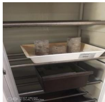
Photo 1 : Éprouvette de béton à la température de 5 °C
