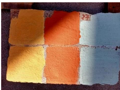
Photo 5 : Résultats des essais de détermination du temps de séchage
